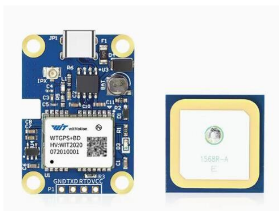
图 1-2 WTGPS+BD 定位模块实物图
