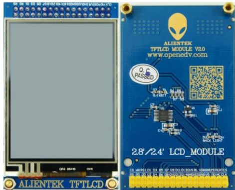
图 1-4 TFTLCD 模块实物图
